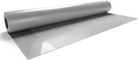
Die PP-Fasern des Vlieses sind speziell ausgebildet, um den Verbund zum Beton zu erhöhen. Das PP-Vlies geht einen mechanisch adhäsiven Verbund mit dem Frischbeton ein und verhindert so zuverlässig und vollflächig eine Hinterläufigkeit zwischen der Betonkonstruktion und dem Frischbetonverbundsystem im Falle ungewollter Beschädigungen.
